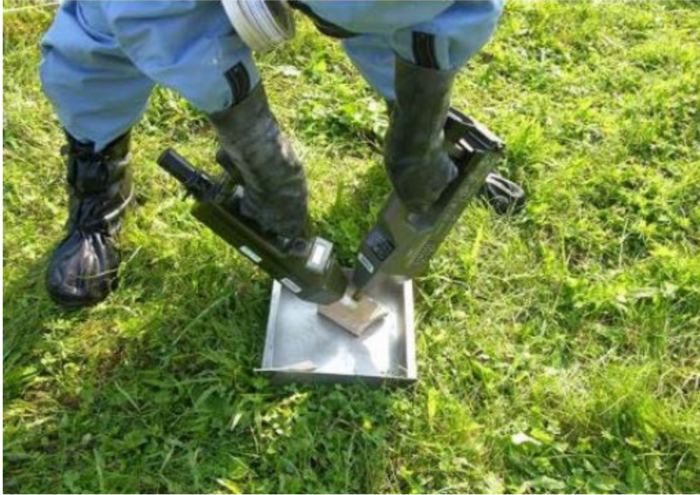
شکل ۲،۲: تصویری از بازرس OPCW هنگام آموزش در جمهوری چک که در حال استفاده از دو آشکارساز با تکنولوژی‌های مختلف
